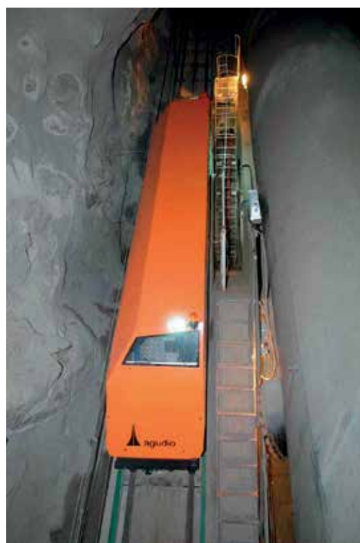
TRANSPORT SUR RAIL Les plans inclinés trouvent des applications dans le transport sur rail de personnes et de charges importantes sur pentes à forte déclivité.
